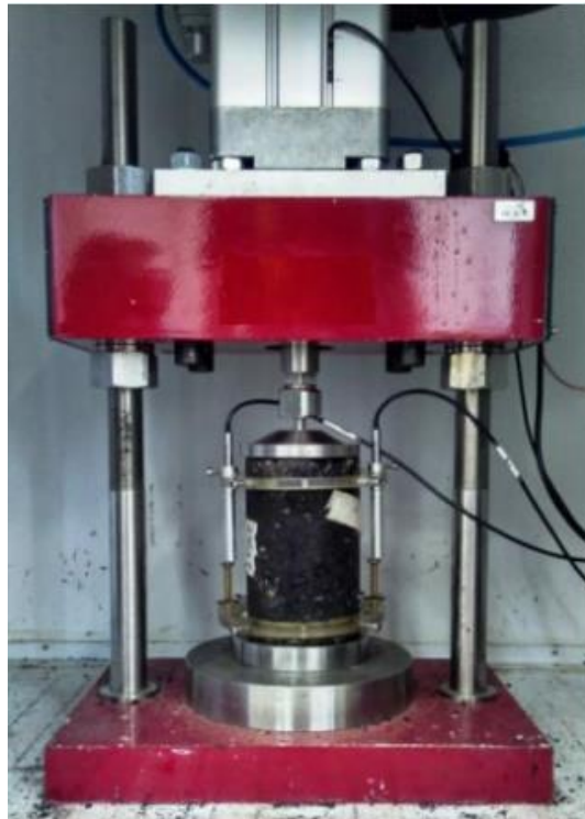
Figura 13 - Esquema de montagem do ensaio de número de fluxo (FN)
