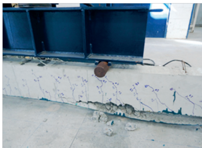
E Configuração da viga VB-5 na ruína
