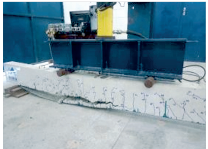
B Configuração da viga VA-2 na ruína
