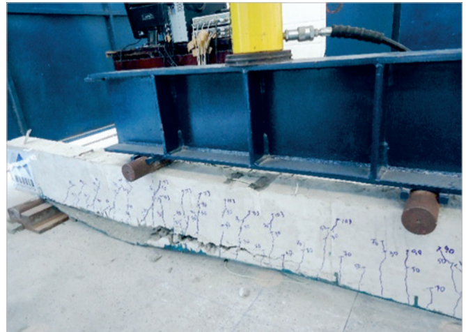
D Configuração da viga VB-4 na ruína
