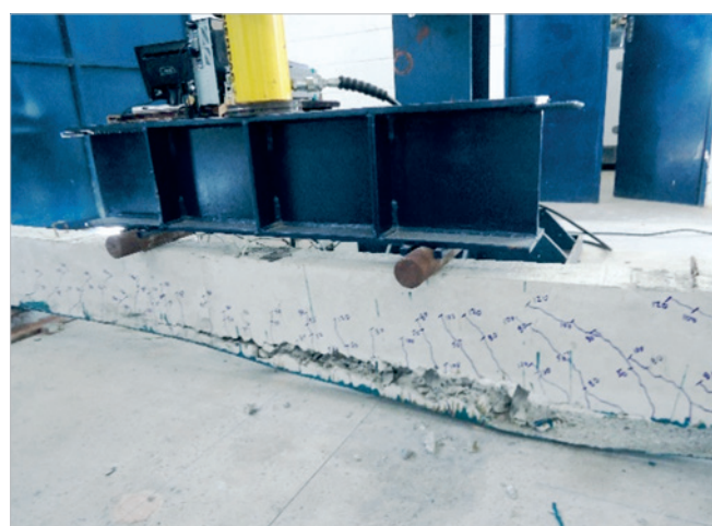
E Configuração da viga VA-5 na ruína
