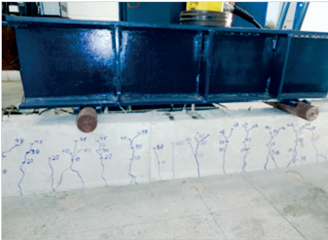
A Configuração da viga VB-R na ruína
