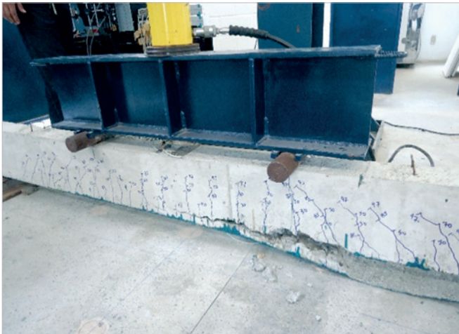
C Configuração da viga VB-3 na ruína
