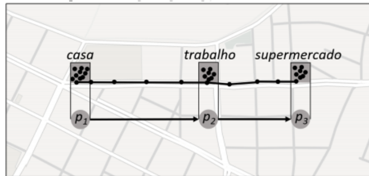
Figura 3 – Resultado da execução de um algoritmo de detecção de pontos de parada.
