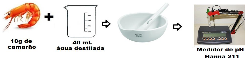
Figura 4 – Fluxograma para medição do pH em camarões ( Litopenaeus vannamei ) armazenados em gelo.
