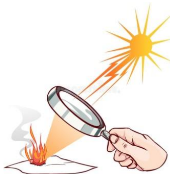
Figura 3 - Lupa como lente convergente.
