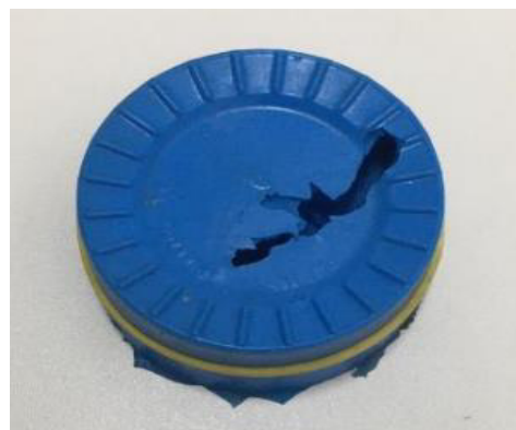
Figura 6 - Molde de silicone para confecção da trava do paraquedas
