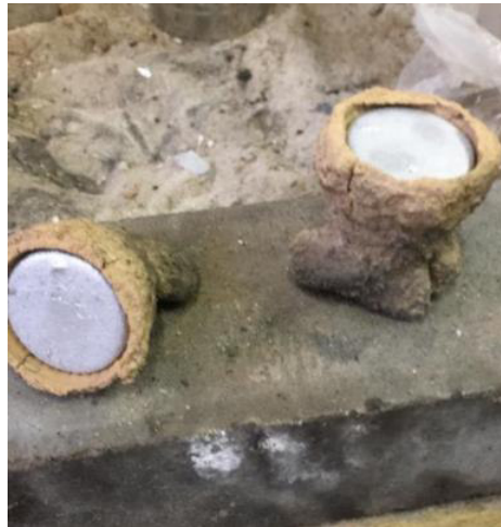
Figura 15 - Cascas cerâmicas após o vazamento de alumínio
