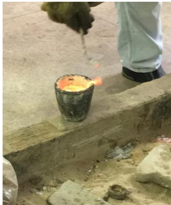
Figura 14 - Retirada da camada de óxido de alumínio do cadinho
