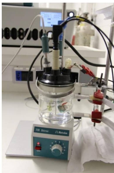
Figura 4. Célula eletroquímica utilizada para o ensaio de temperatura crítica de pite.
