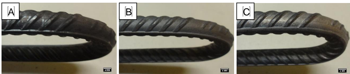
Figura 3. Amostras dobradas, (A) Amostra RA, (B) Amostra 63%P, (C) Amostra 100%P. Fonte: Autor.
