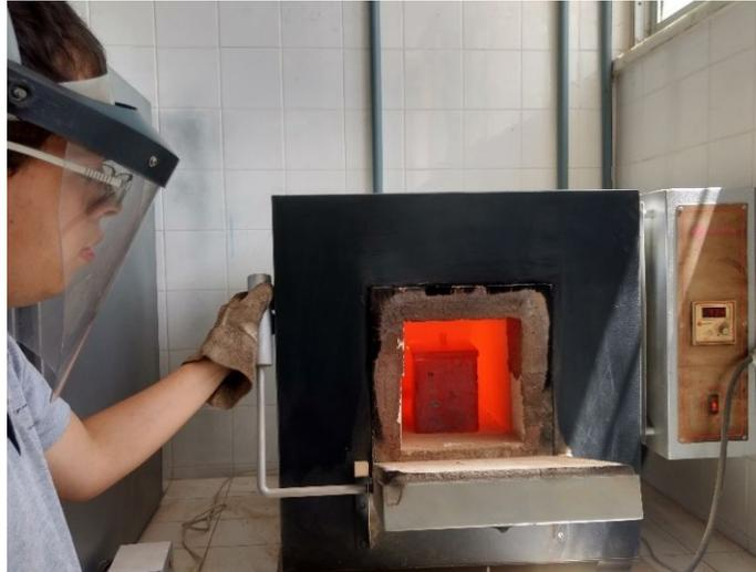
**Figura 3.** Caixa de aço colocada em forno mufla a 920°C. Fonte: Autor.
