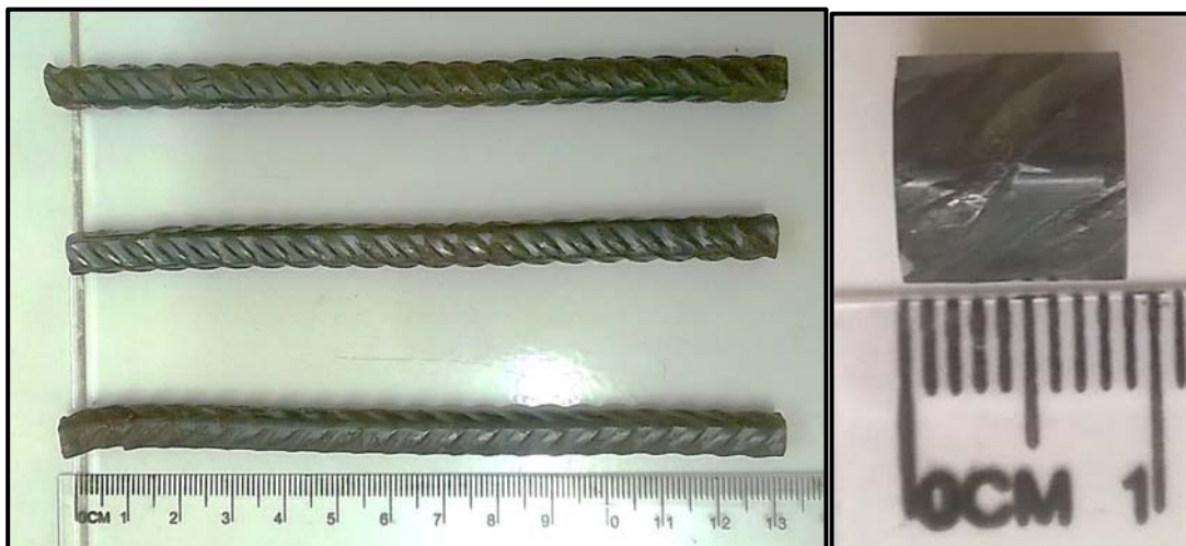
Figura 1 - Amostras cortadas a) para tração e b) para metalografia
