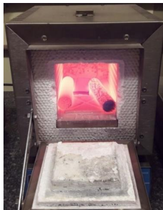
Figura 3. Forno tipo MUFLA contendo as amostras ABNT 1045 e ABNT 4140, à esquerda e direita respectivamente, ao serem retiradas na etapa de normalização. Fonte: Elaborada pelo autor
