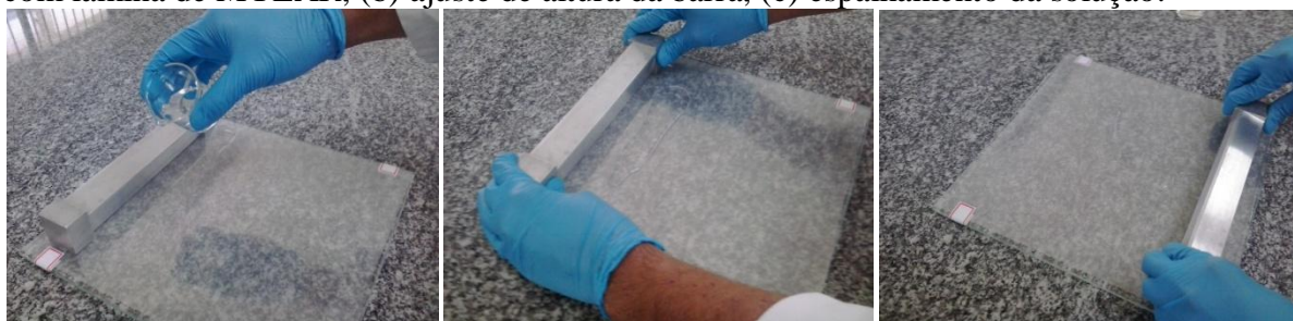
Figura 14 — Obtenção dos filmes por casting : (a) distribuição da solução em placa de vidro com lâmina de MYLAR, (b) ajuste de altura da barra, (c) espalhamento da solução.
