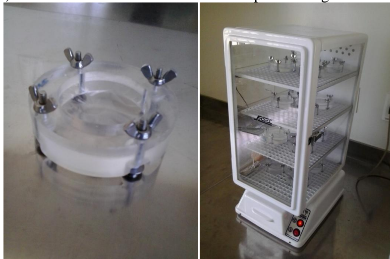
Figura 16 — Sistema para ensaio de permeabilidade ao vapor de água: (à esquerda) corpo de prova e (à direita) dessecador com ambiente controlado pela sílica gel.
