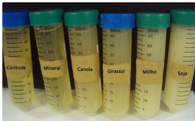
Figura 18: Tubos com óleos vegetais e mineral após centrifugação com a cepa RAB9.
