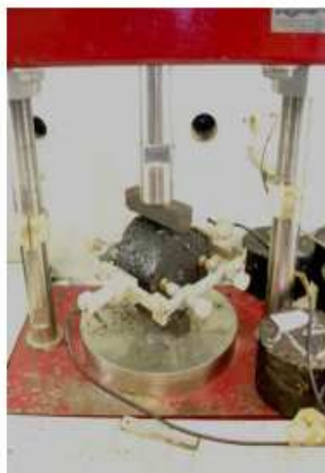
Figura 3.11 Ensaio de módulo de resiliência (LMP/UFC).
