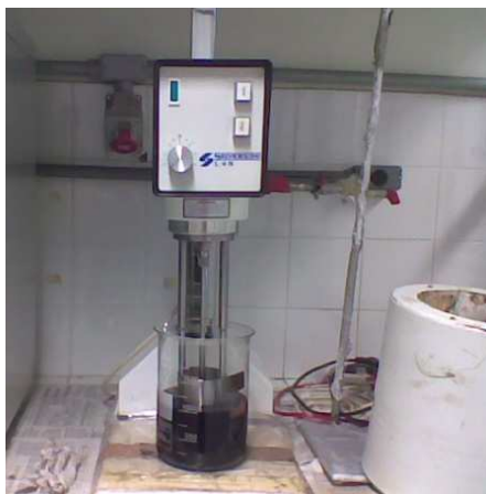
Figura 3.2 Misturador de alto cisalhamento usado para modificação de ligante (LMP/UFC).
