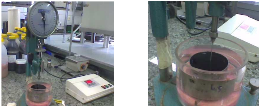
Figura 3.3 Ensaio de penetração (realizados na empresa Asfaltos Nordeste/Fortaleza-Ce).
