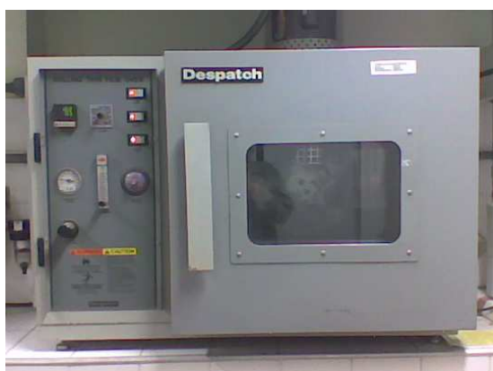
Figura 3.8 Estufa para RTFOT (LMP/UFC).
