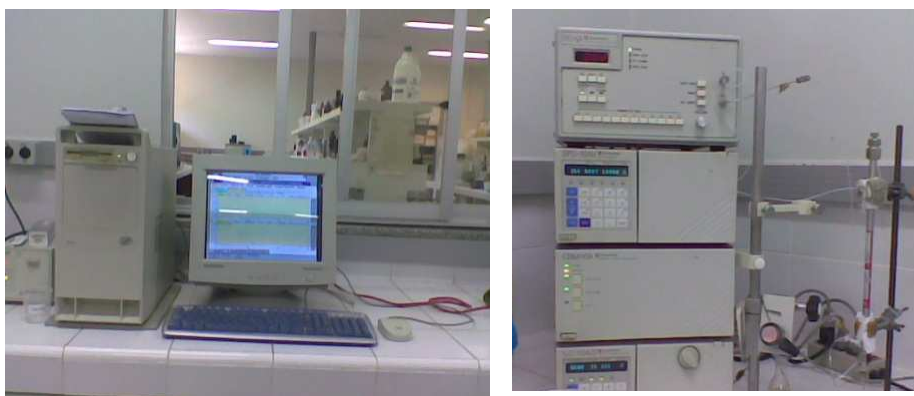
Figura 3.9 Equipamento de Cromatografia de Permeação em Gel (Laboratório de Polímeros da UFC).
