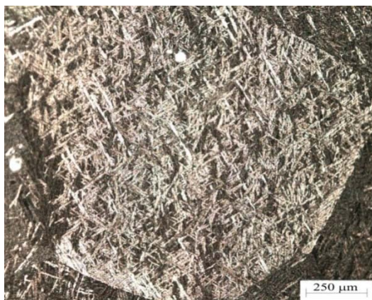
Figura 2. Micrografia após aquecimento 650°C por 2h - aumento de 100x
