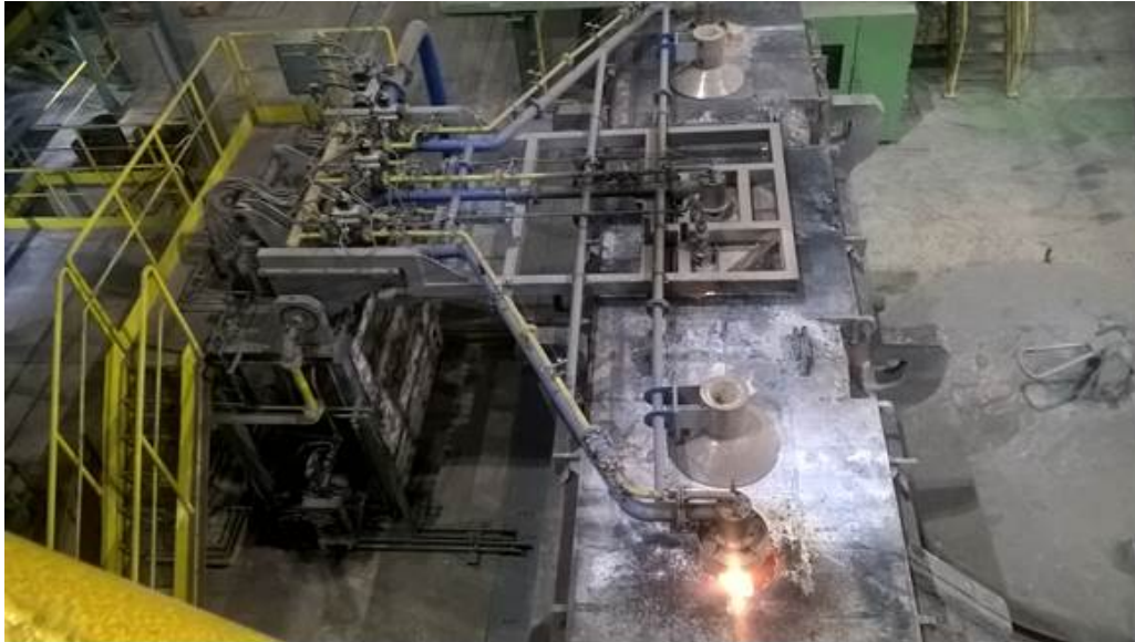
Figura 3. Foto de um secador de distribuidores em fase de aquecimento
