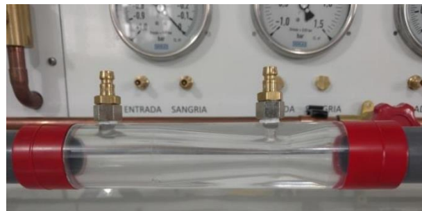
Figura 18 - Tubo de Venturi.
