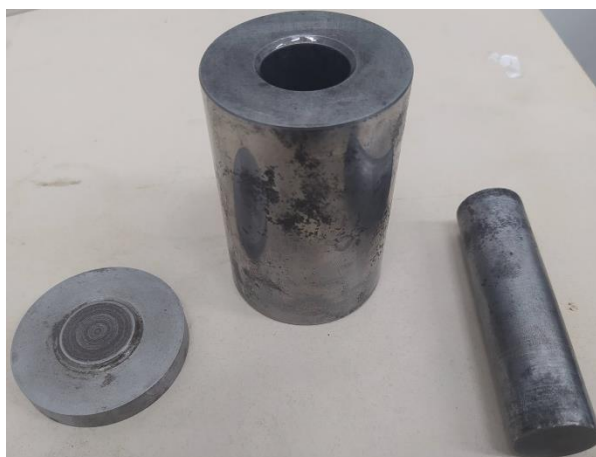
Figura 2 – Molde metálico para a compactação dos corpos de prova
