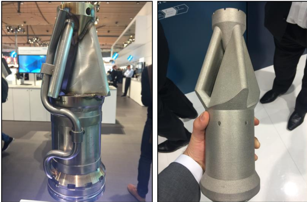
Figura 30 - Combustor de turbina a gás produzido por manufatura convencional (à esquerda) e impresso (à direita)
