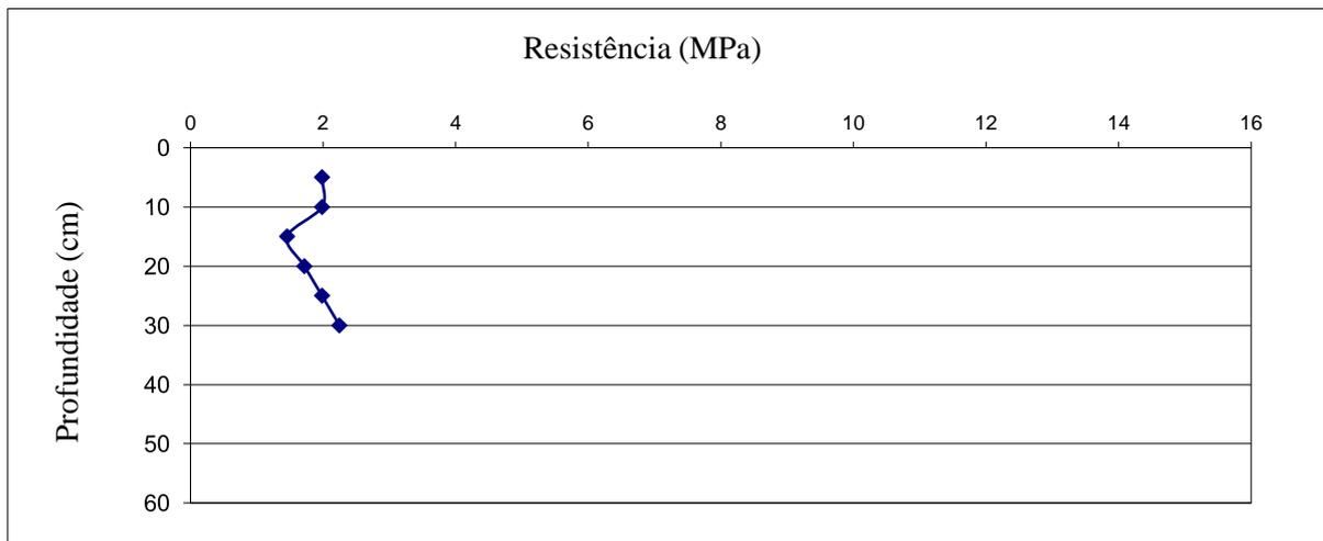
Figura 8 - Resistência a penetração do solo em subparcela do experimento (tratamento L4C1)
