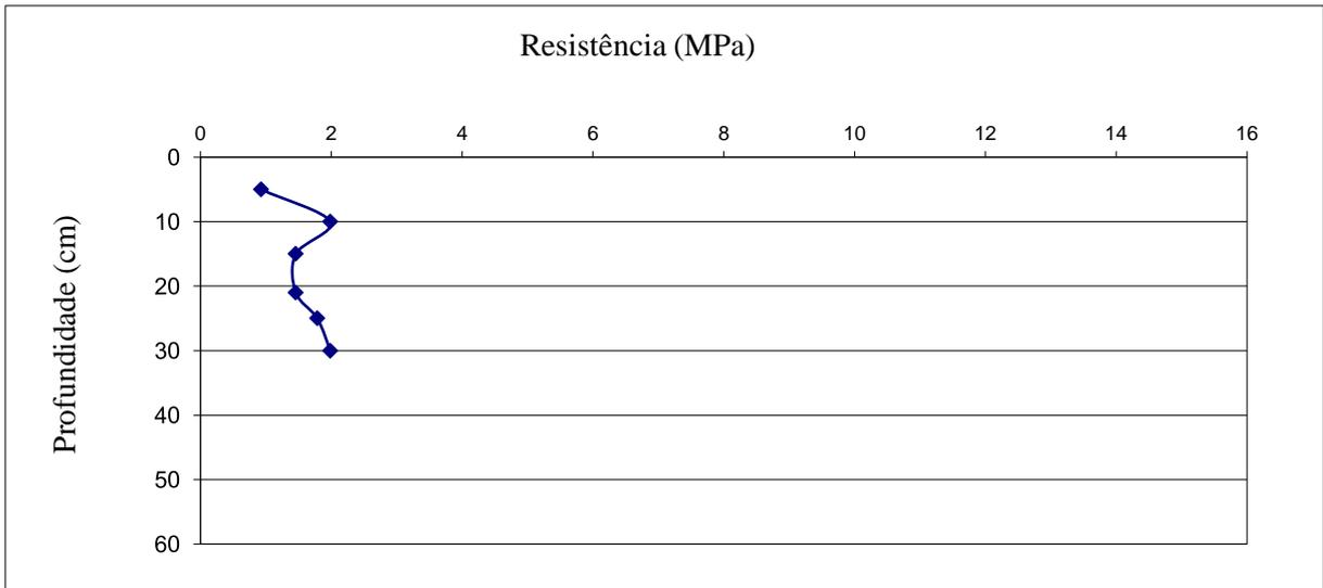
Figura 9 - Resistência a penetração do solo em subparcela do experimento (tratamento L2C3)
