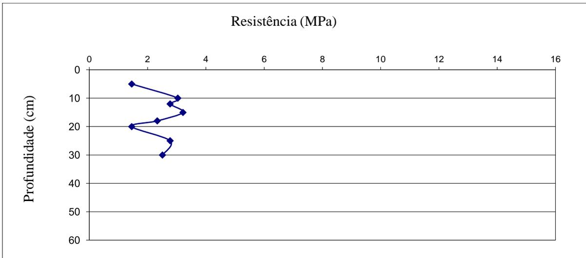
Figura 3 - Resistência a penetração do solo em subparcela do experimento (tratamento L3C1)
