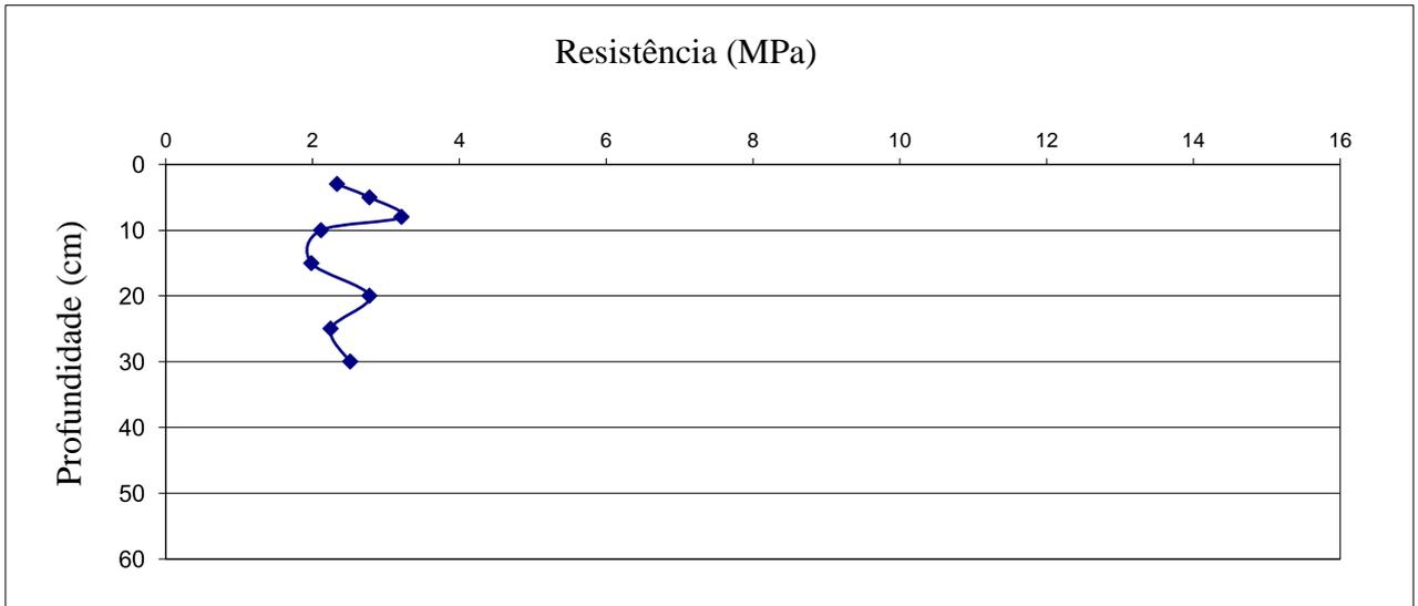
Figura 38 - Resistência a penetração do solo em subparcela do experimento (tratamento L2C2)
