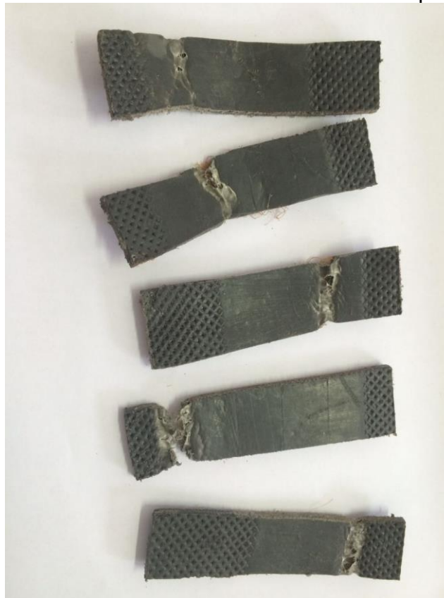
Figura 2. Corpos de prova do compósito resultante ensaiados.
