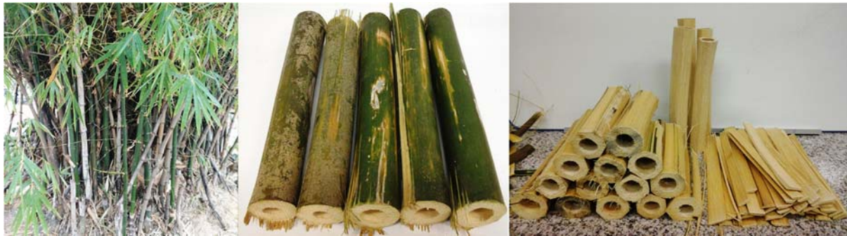
Figura 2: Processo de corte dos bambus. Seguindo a ordem de corte dos colmos, tem-se: corte dos entrenós, descascamento e corte em lascas para obtenção das fibras longas, curtas e particuladas. fonte: Próprio autor
