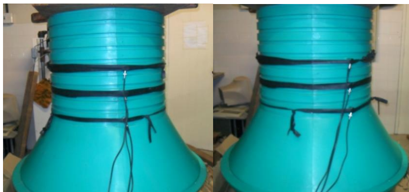
Figura 4 - Ensaio de emissão acústica na chaminé do PV na posição 1 e na posição 2 (+15cm).
