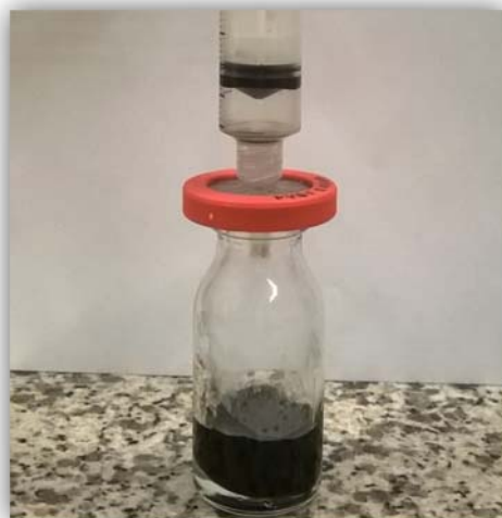
Figura 3: Nanocelulose sendo filtrada após a sonicação
