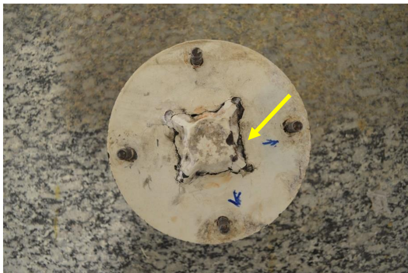
Figura 7. Peça 1 com região do eixo fraturada indicada pela seta onde a mesma situação ocorre para as peças 2 e 3.
