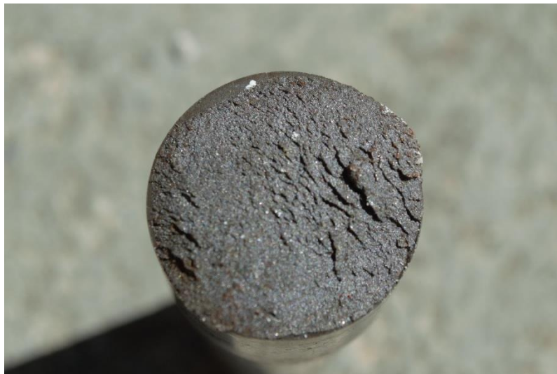
Figura 6. Figura de eixo fraturado pertencente à peça 4
