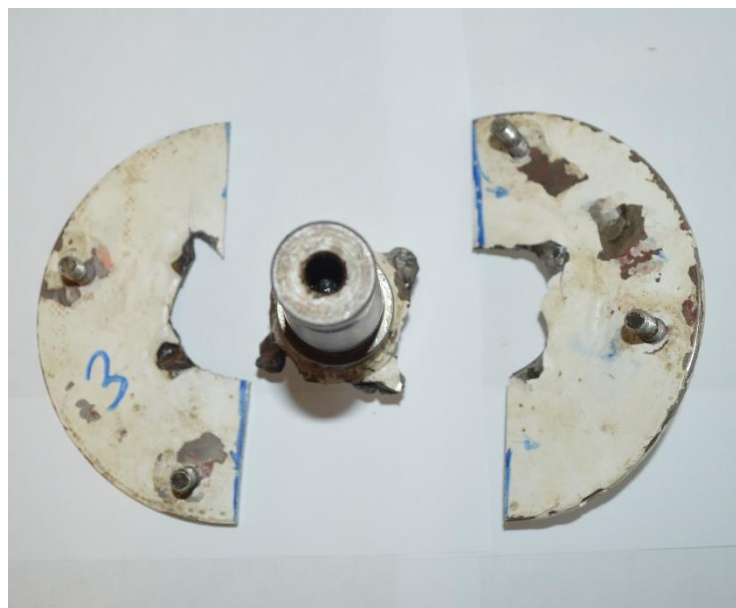
Figura 2. Eixo cortado para visualização da região fraturada na região de solda
