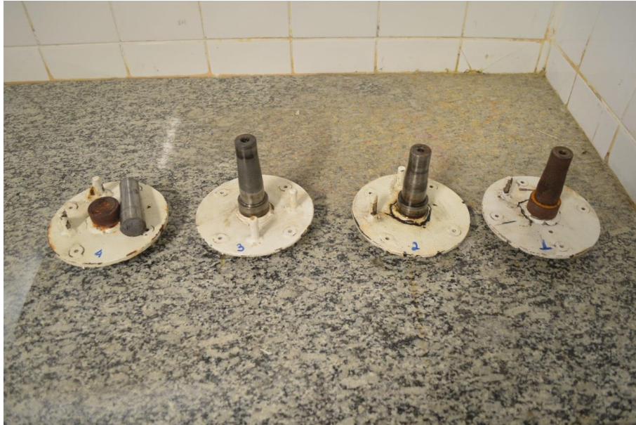
Figura 1. Eixos soldados aos flanges e numerados, como recebidos.
