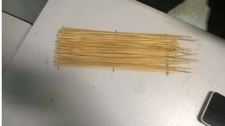
Figura 1. Forma que as fibras foram dispostas no compósito.
