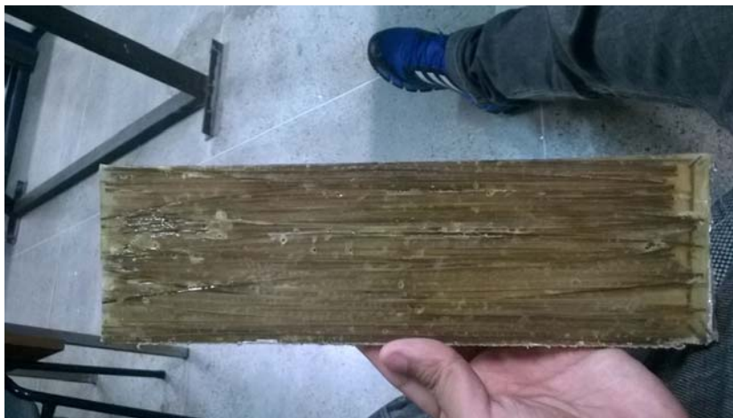
Figura 2 . Placa do compósito já fabricada
