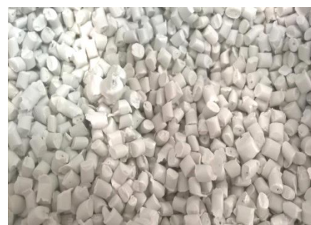
Fonte: próprio autor. Figura 2 : PPI reciclado
