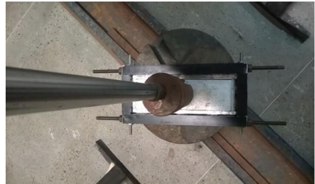
Figura 9: Molde sob ação da prensa
