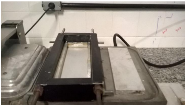
Fonte: próprio autor. Figura 1: Molde Confeccionado
