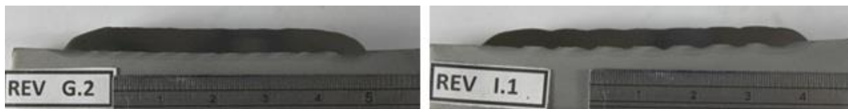
Figura 2. Seção transversal do revestimento de menor e maior diluição
