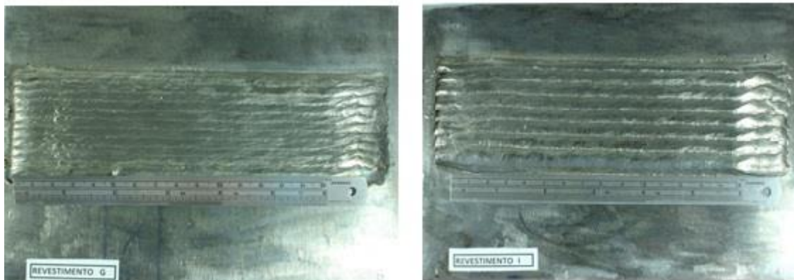
Figura 1. Aspectos superficiais do revestimento
