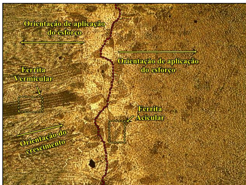
Figura 8. Orientação do crescimento epitaxial de grãos na zona fundida das amostras similares do aço inoxidável austenítico AISI 316L. Amostra soldada com frequência F0. (Reagente HNO 3 ; aumento de 50 X).
