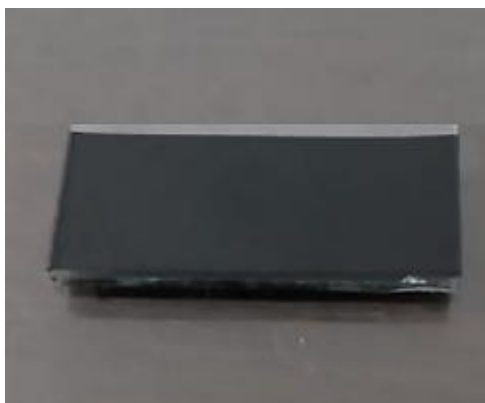
Figura 42: Lâmina de vidro coberta com tinta preta.
