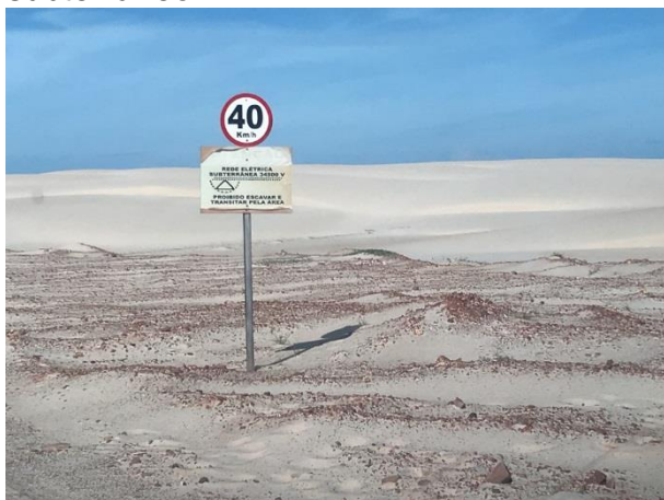
Figura 35 - Placa de sinalização de velocidade e de alerta de cabeamento subterrâneo.
