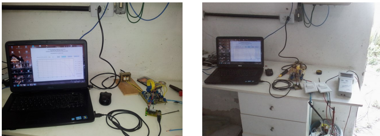
Figura 7 – Traçador desenvolvido (esquerda), traçadores desenvolvido e comercial utilizados no processo de validação.
