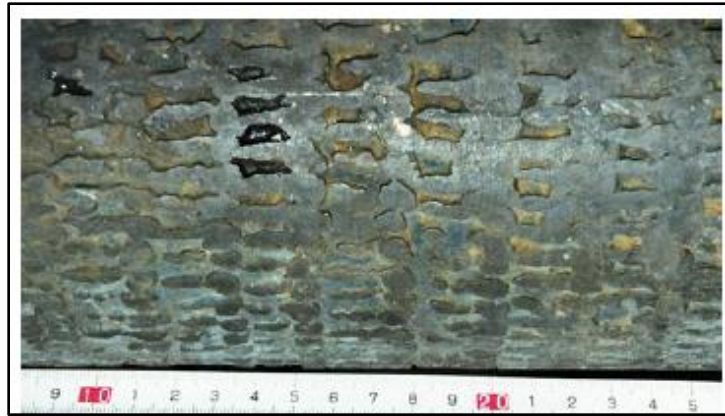
Figura 9 - Corrosão induzida por fluxo de molde.
