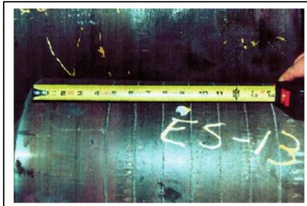
Figura 8 - Corrosão intergranular em rolos de lingotamento contínuo.
