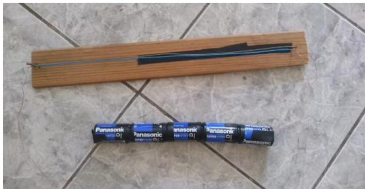
**Figura 53 - Experimento Fio atrai Fio.**
