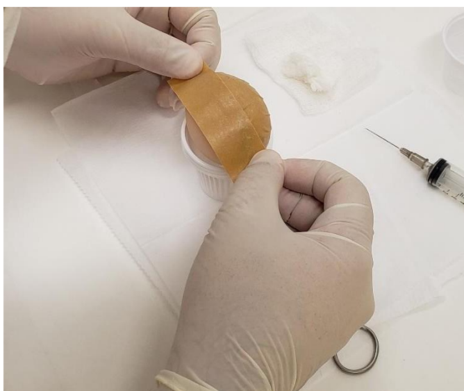
Figura 5: Tiras adesivas sendo coladas na superfície da casca.
