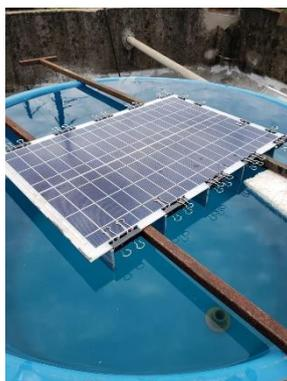
Figura 4 - Módulo modelo KS20T com aletas em sua superfície posterior sobre tanque d'água.
