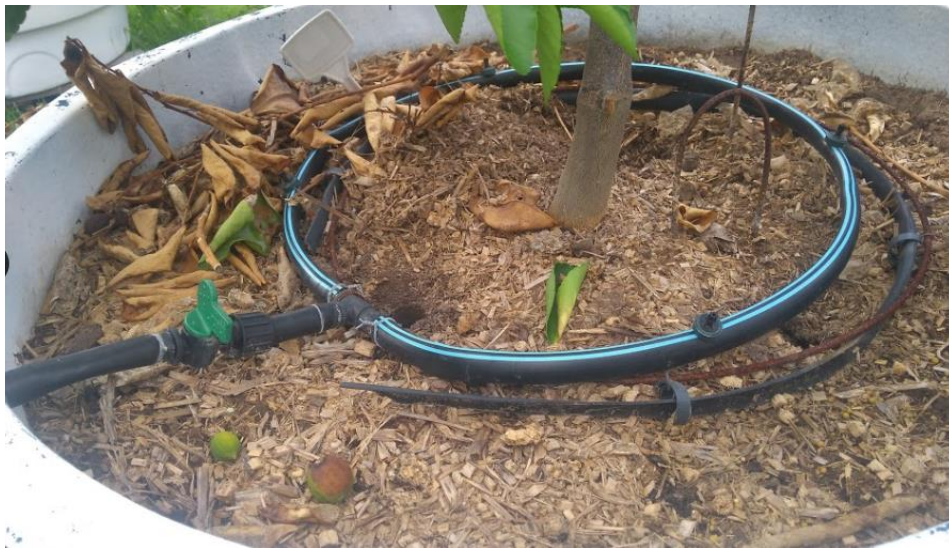
Figura 5. Sistema de irrigação por gotejamento instalado nos lisímetros de drenagem, Pombal, PB, 2017.
