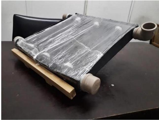
Figura 1 – Protótipo de coletor solar térmico de baixo custo. Esse protótipo destaca-se pela possibilidade de ser reproduzido no ambiente escolar pelos estudantes. Fonte: Os autores.
