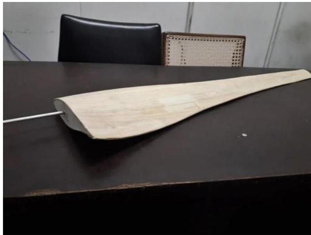
Figura 2 – Modelo de pá eólica construído em dimensões reduzidas. Fonte: Os autores.
