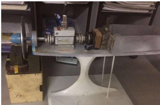
Figura 4 – Bancada de testes durante a realização do ensaio com protótipo de freio de correntes induzidas.
