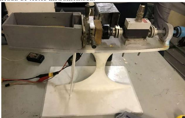
Figura 3 – Bancada de testes para medição de torque e rotação.
