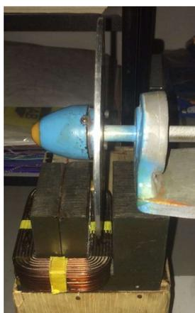
Figura 2 – Protótipo de freio elétrico em escala reduzida
