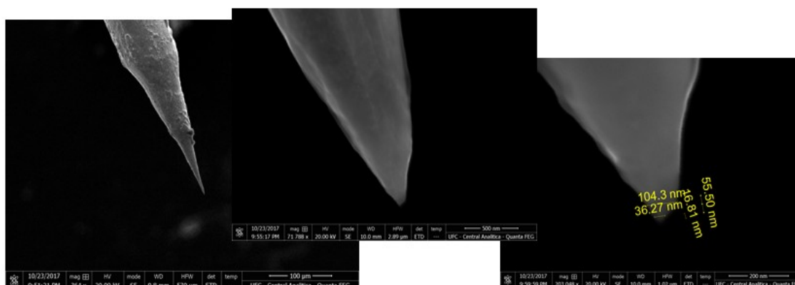
Figura 54: Ponta com o ápice \approx 40 nm , superfície lisa.
