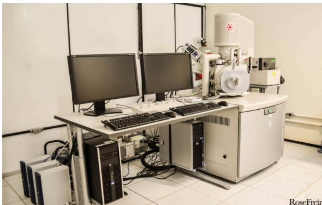
Figura 7: Os equipamentos utilizados em três diferentes caracterizações realizadas na amostra de PDMS-Au, (a) o Quanta-450 do fabricante FEI e (b) Raman Renishaw .
