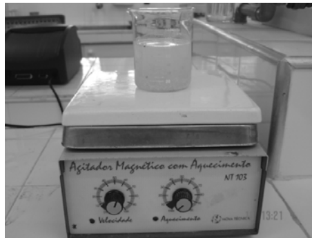
Figura 3: Solução de pó da semente de moringa sendo agitada em um béquer
