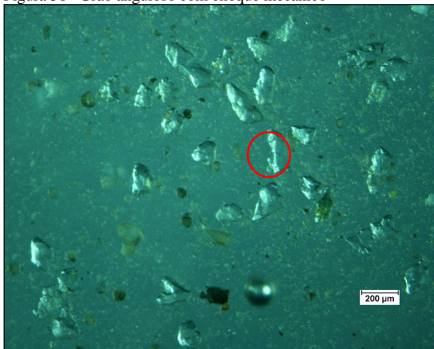
Figura 56– Grão anguloso com choque mecânico
