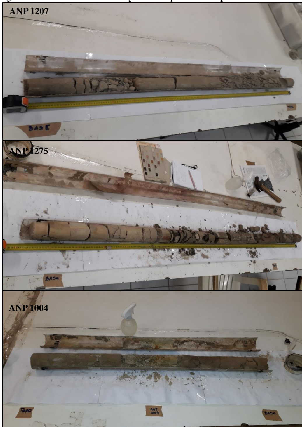
Figura 12- Divisão do testemunho para descrição macroscópica
