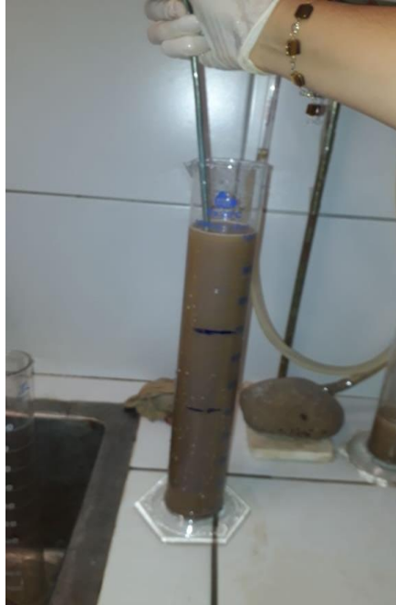
Figura 14- Mistura do sedimento com coagulante
