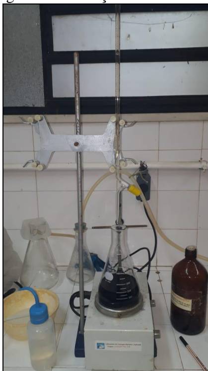
Figura 18- Titulação com sulfato Ferroso amoniacal
