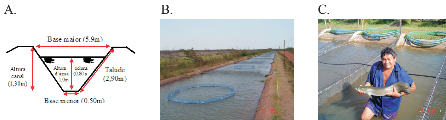
Figura 5.4 Canal de irrigação do DITALPI/DNOCS, com formato trapezoidal (A), seccionado com tela para cultivo de tilápia Oreochromis niloticus (B) e pirarucu, Arapaima gigas (C) no momento da despesa. Seta indica tela das seções e cabeça de seta comedouro em forma de anel utilizado
