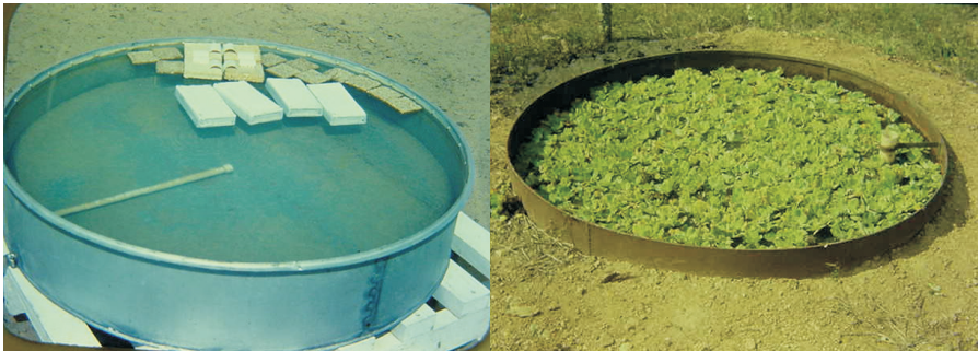
Figura 3.13 Tanque de evaporação classe “A” contendo alguns dos tratamentos testados para redução da evaporação
