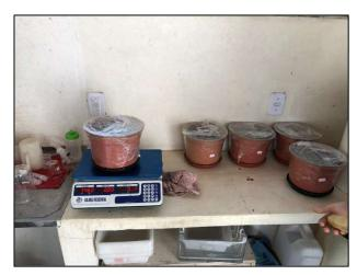
Figura 1. Determinação da capacidade de retenção de água.
