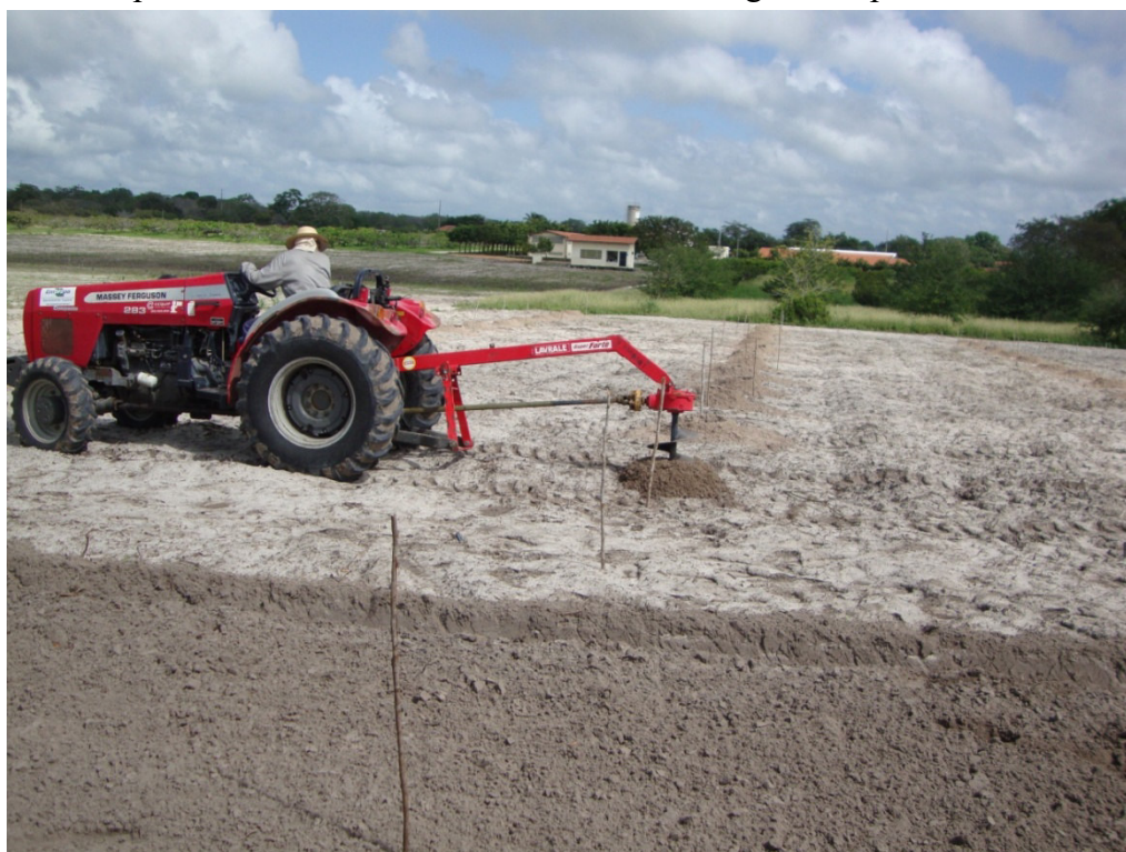
Figura 2 - Abertura das covas de plantio realizado por meio de trator e do implemento “broca de rosca”. Autor: Luiz Augusto Lopes Serrano.
