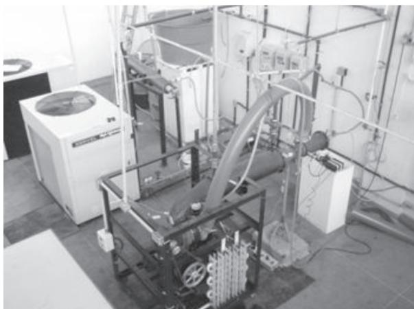
**Figura 3:** Sistema de microcogeração.
