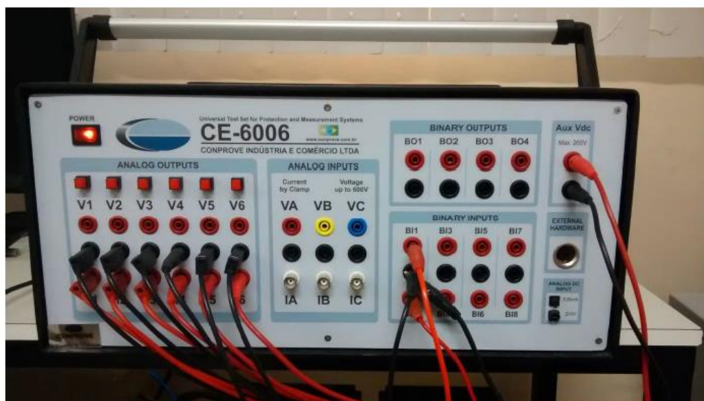
Figura 3- Testador Universal Hexafásica
