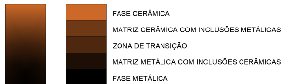
Figura 2 – Materiais com gradação funcional - gradação contínua e descontínua.
