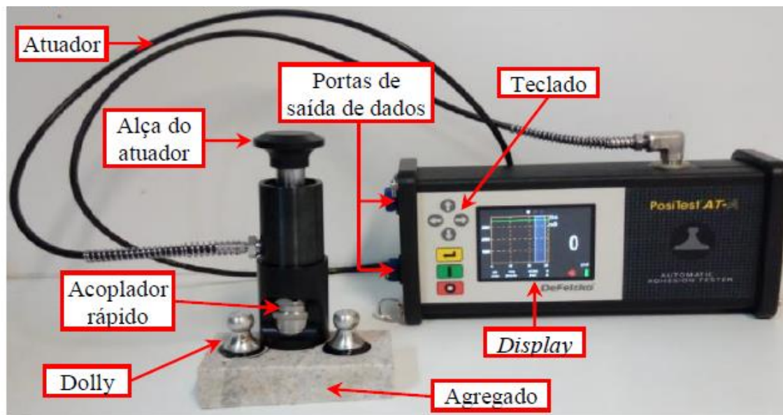
Figura 24: Equipamento utilizado no ensaio de arrancamento do Stub
