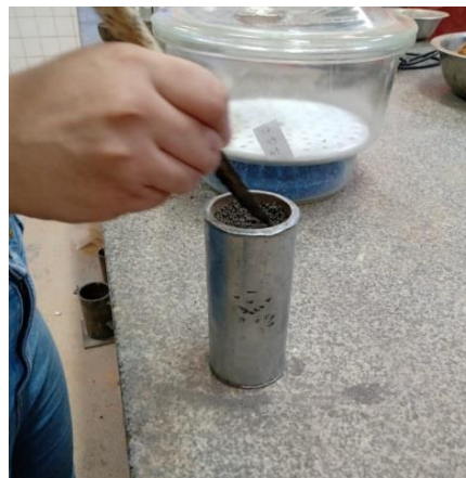
Figura 3.9 –Ranhura entre as camadas do corpo de prova.
