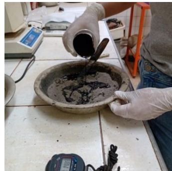
(f) Colocação da emulsão no solo.
