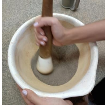
(a) Destorroamento do solo.
